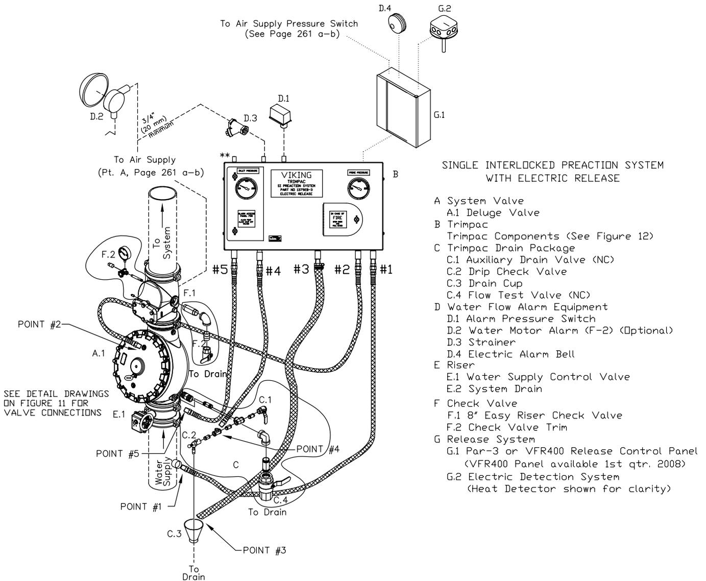
**SINGLE INTERLOCKED PREACTION SYSTEM WITH ELECTRIC RELEASE**
