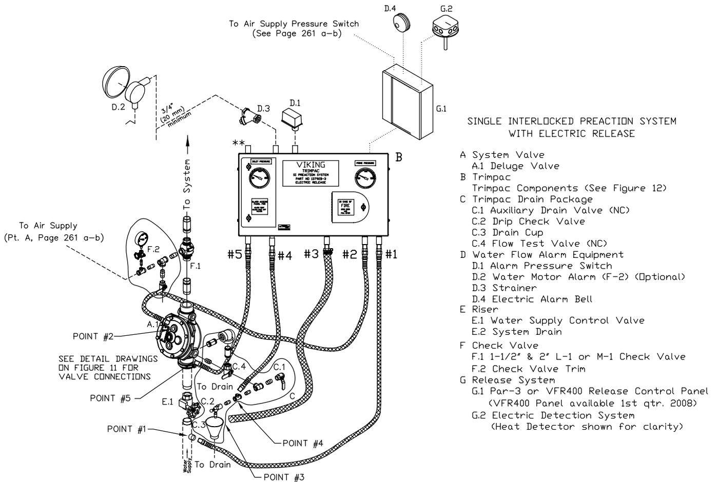
SINGLE INTERLOCKED PREACTION SYSTEM WITH ELECTRIC RELEASE
